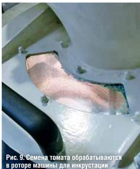
Рис. 9. Семена томата обрабатываются в роторе машины для инкрустации
