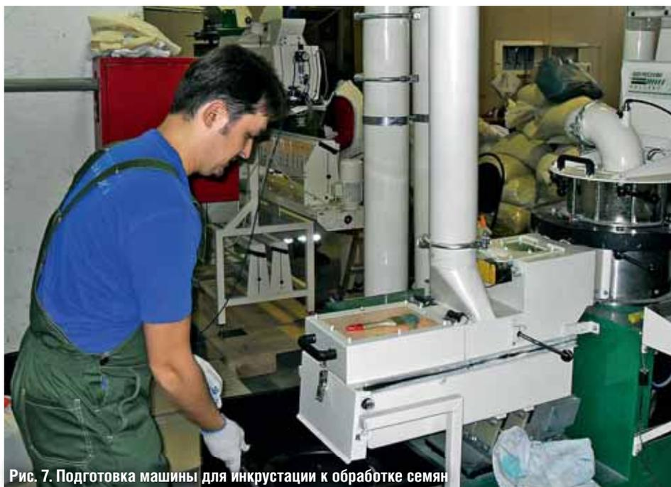
Рис. 7. Подготовка машины для инкрустации к обработке семян
