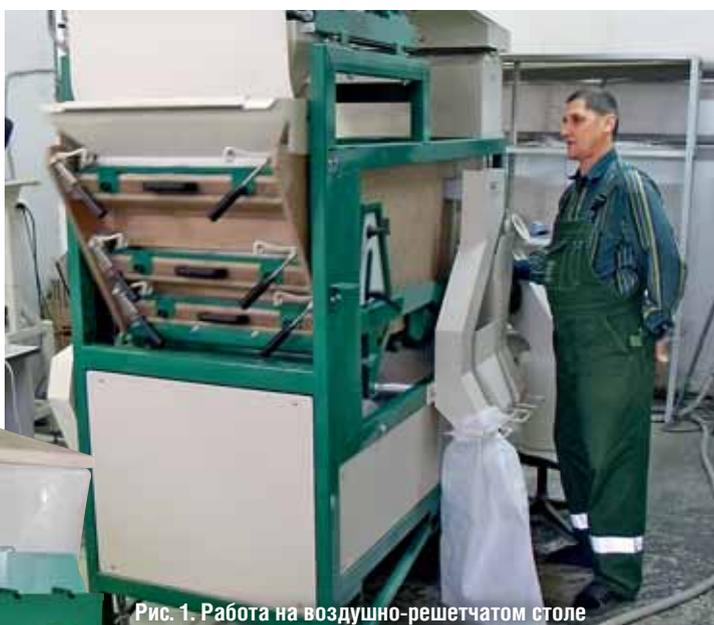
Рис. 1. Работа на воздушно-решетчатом столе
