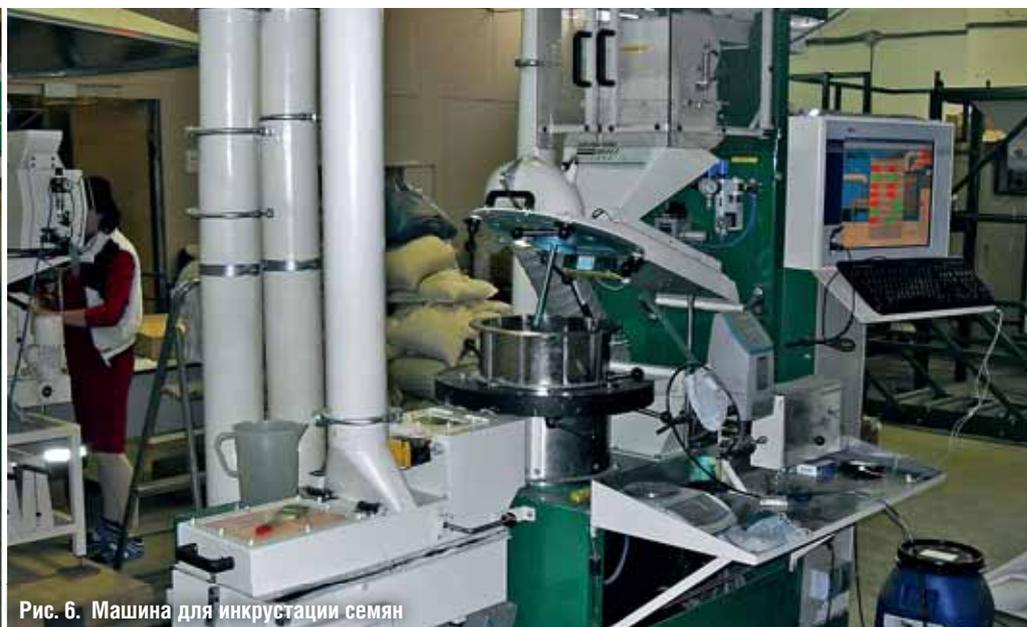
Рис. 6. Машина для инкрустации семян
